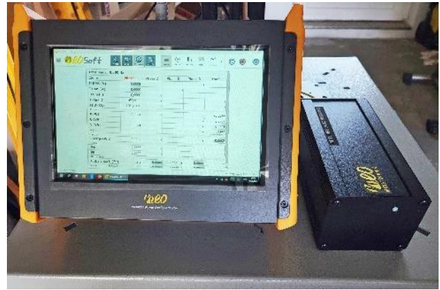
Bild 14 Prototypen eines kommerziellen Messgerätes für eine kombinierte PQ- und Netzimpedanzmessung
