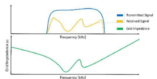
Bild 2: Relation PLC Übertragungsverluste und höher-frequente Netzimpedanz
