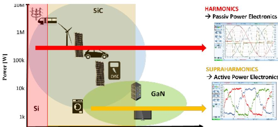
Bild 3: Supraharmonische Emissionen durch aktive Leistungselektronik
