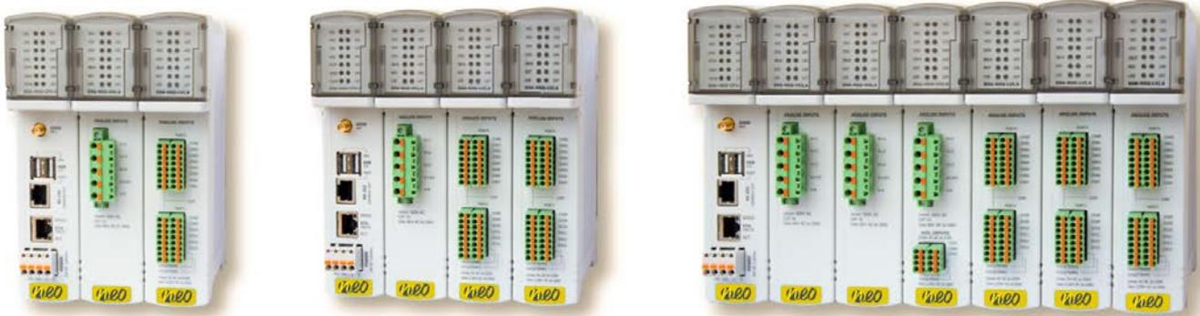
Das PQM-100 Gerät basiert auf einer **modularen Architektur**. Es können - neben dem CPU Modul 6 - weitere, frei wählbare Module pro Gerät angeschlossen werden. Alle Module erfüllen gängige Sicherheitsanforderungen (CAT IV 300V) und wandeln die analogen Signale direkt in digitale Signale um. Das CPU Modul ist mit einem FPGA Real-Time Controller ausgestattet und berechnet alle Parameter direkt am Gerät. Über verschiedene Schnittstellen können Daten einfach übertragen werden.
